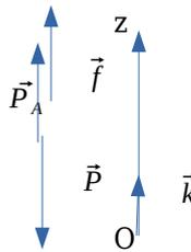
Nous constatons sur les graphique qu'à partir de 0,45 s la vitesse des billes est constante et puisque leur mouvement est rectiligne, le mouvement est rectiligne uniforme donc d'après le principe d'inertie
